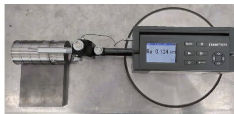
(a) 工件表面粗糙度的测量
