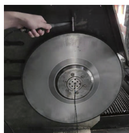
(a) 砂轮的锤击试验
